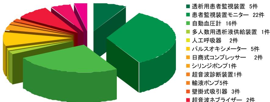
平成 25 年 ME 機器中央管理の修理件数は相変わらずベッドサイド患者監視装置の修理依頼件数が 22 件と多くありました、ベッドサイド患者監視装置は患者様に直接心電図を測定するケーブルや酸素飽和度 SPO<sub>2</sub> を測定する装置を接続する為に破損やケーブルの断線が多く発生し、修理依頼件数も多くなったと考えられます。
